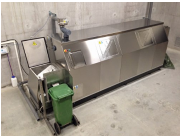
Figura 101: La compostiera automatica acquistata dal Comune di Riccia – Fonte: Comune di Riccia, Riccia. Il borgo del benessere, presentazione powerpoint per gentile concessione del Comune di Riccia.
